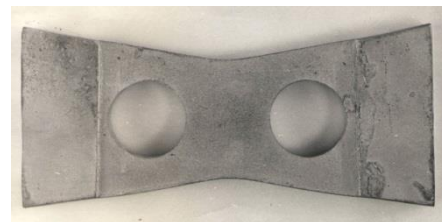
Рисунок 2 – Молоток дробарки тришаровий композиційний матеріал, суцільний КХЖ50+КХЖ85+КХЖ50 Наробіток на одну грань – 900-1100 т.
