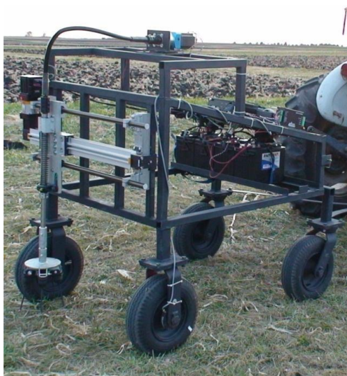
Рисунок 3 – Покращений прототип із зміненим положенням двигуна механізму прополювання
