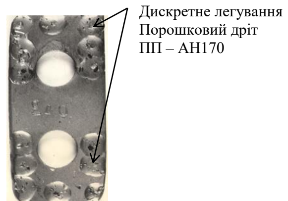
Рисунок 4 – Дугове точкове зварення ДТЗ дискретне легування Порошковий дріт ПП – АН170 Наробіток на одну грань – 450 – 600 т.
