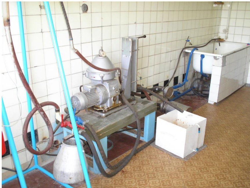
Рисунок 2 – Загальний вигляд експериментальної установки для дослідження технологічного процесу охолодження молока
