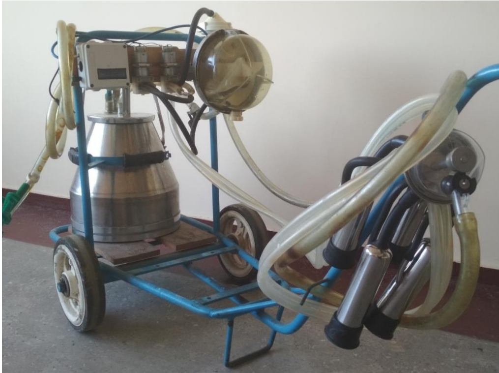
Рисунок 3 – Макетний зразок адаптивної доїльної апаратури на базі порційного лічильника вагового типу
