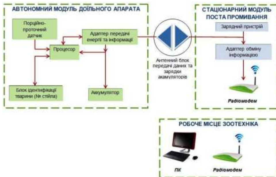
Рисунок 1 – Структурно-технологічна схема АСУТП для ферм з доїнням корів у стійловий молокопровід
