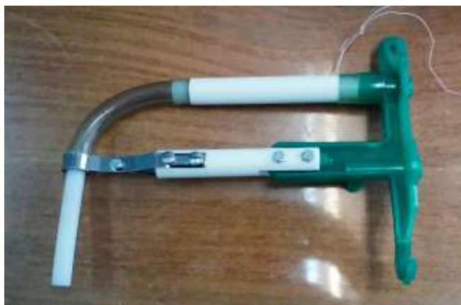
Рисунок 3 – Загальний вигляд проточного датчика витрати молока ємнісного принципу дії
