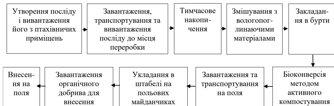
Рисунок 1 – Блок-схема технології біоконверсії шляхом активного компостування в буртах
