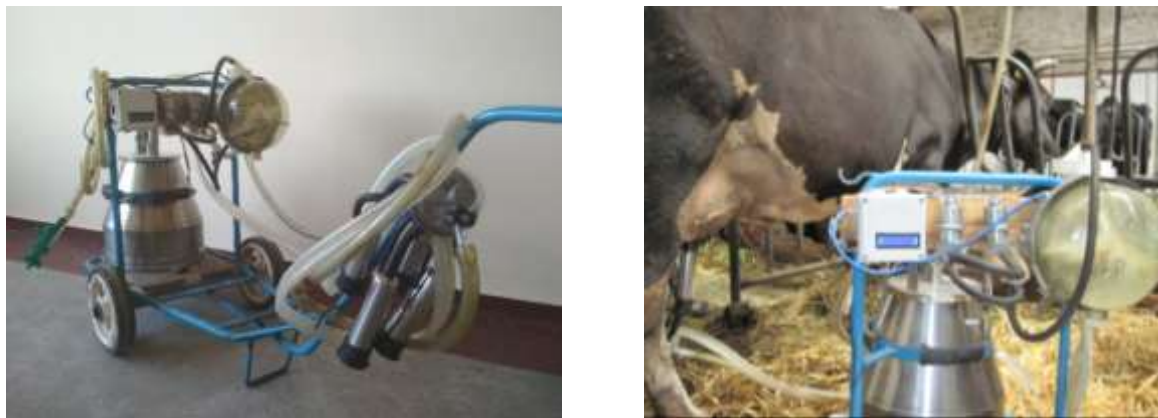
Рисунок 2 - Загальний вигляд доїльного апарата з експериментальним блоком керування для адаптивної зміни режиму роботи
