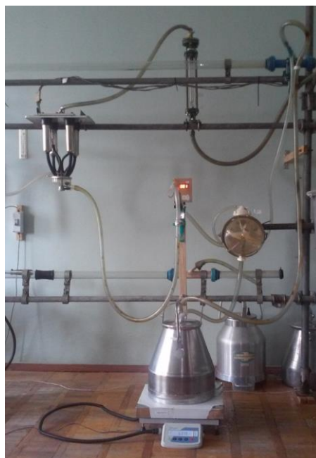
Рисунок 3 – Загальний вигляд лабораторного станда для досліджень лічильника при доїнні в нижній молокопровід (лабораторна імітація доїльного зала)
