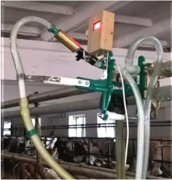
Рисунок 2 - Загальний вигляд макетного зразка автоматичного лічильника індивідуального надою на базі ємнісного датчика проточного типу під час виробничих досліджень.
