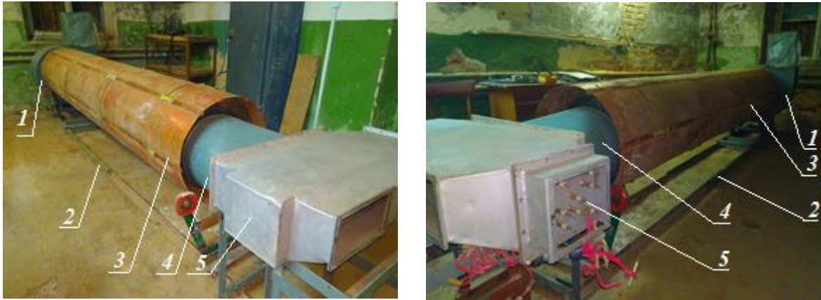
Рисунок 3 – Загальний вигляд дослідного зразку барабанної сушарки: 1 – вентилятор відцентровий; 2 – рама; 3 – барабан; 4 – дифузор; 5 – нагрівальний елемент.
