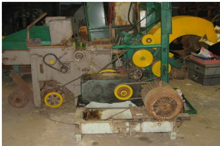
Рисунок 1 – Експериментальна установка для вивчення доподрібнення зерна кукурудзи та питомої енергоємності процесу
