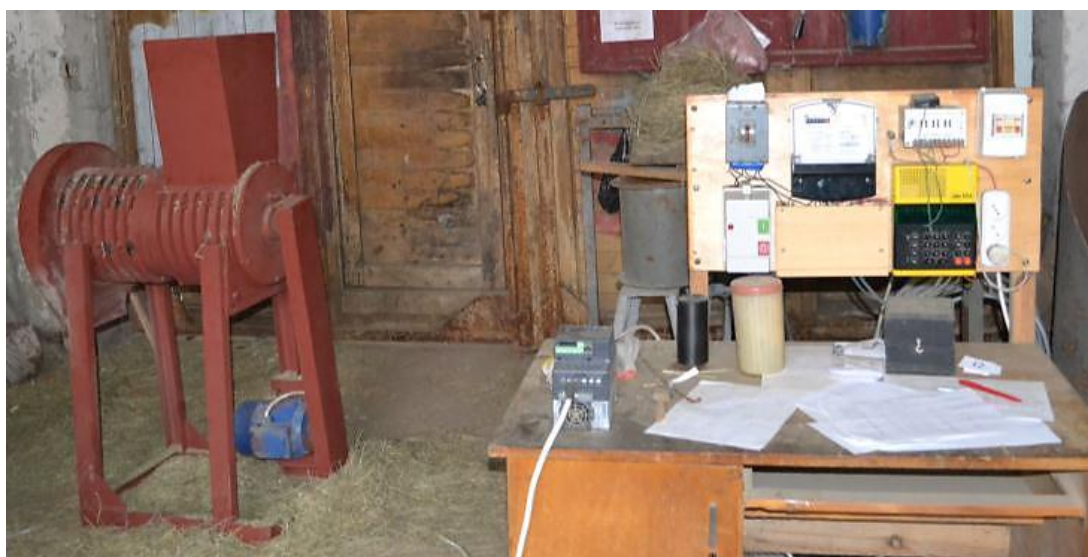
Рисунок 1 – Експериментальний зразок подрібнювача грубих кормів та стенд для вимірювання витрат енергії і регулювання частоти струму
